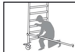
**4** Sett et horisontalstag i samme høyde på motsatt ende av rammen. Hvis du har et rullestillas med dobbel bredde (1,35 m), bruker du to horisontalstag i stedet for ett.
